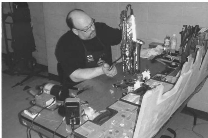
*Vérification d'un saxophone à l'aide d'un tube fluorescent.*
