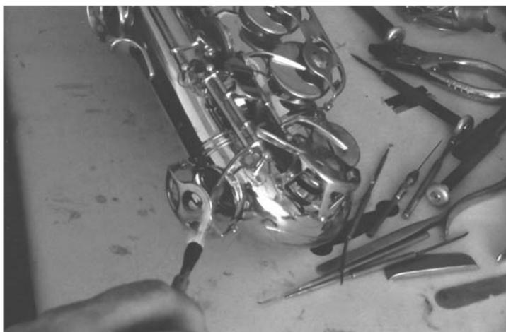
Soudure sur une clé d'un saxophone
